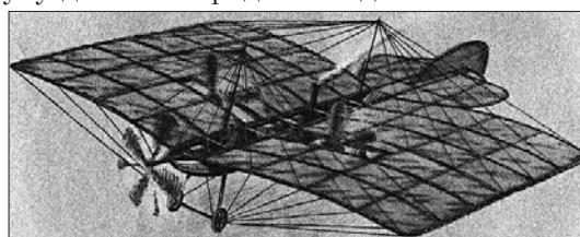
Рис. 6. «Воздухолетательный снаряд» А. Ф. Можайского
